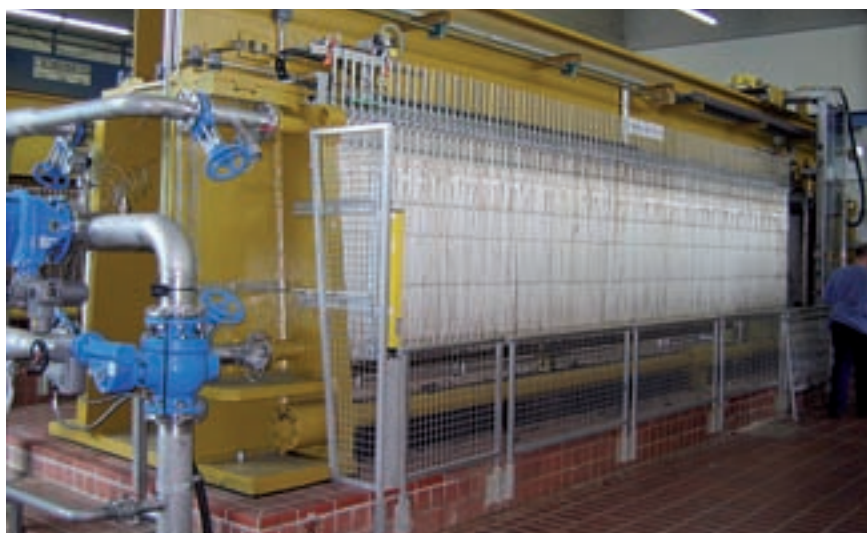
Kammerfilterpresse mit Beschickungszulauf DN 150/PN 40, max. 3 MPa (435 psi)
